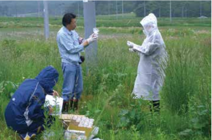
文部科学省職員が来村し、土壌汚染の状況を確認するため、表層 5cm の土壌を採取し、ゲルマニウム半導体検出器を用いて核種分析を実施しました。
